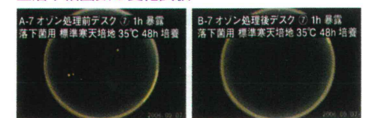
オゾン処理前(細菌コロニー数:4個) オゾン処理後(細菌コロニー数:0個) 2006/09/07 大阪府立産業技術総合研究所調べ
